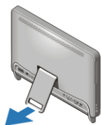
Figura 3. Instalarea suportului din spate
